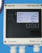
Alto grado de seguridad de Controlador de dosificaciones Rx33, registra la señales de salida y entrada de caudal y control de válvula y bombas, también maneja los cálculos de energía térmica, entre otros
